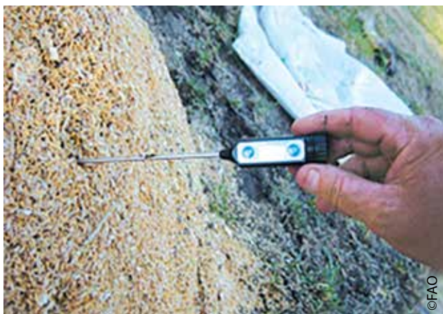
Hình 60. Kiểm tra nhiệt độ đồng ủ
