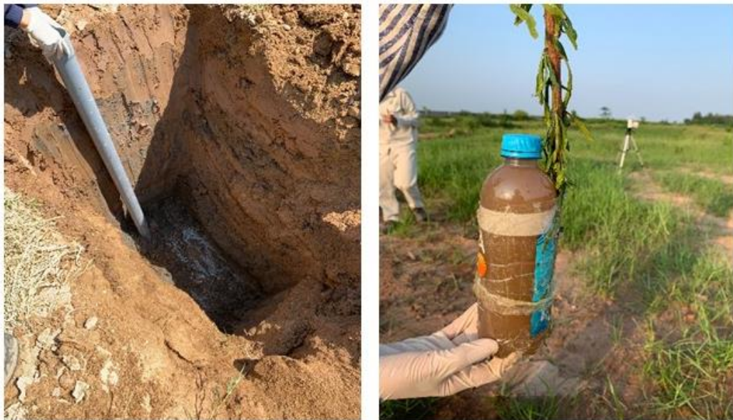
Hình 4.2. Lắp đặt hệ thống thu nước ngầm tại điểm chôn lấp và lấy mẫu nước dưới đất tại điểm chôn lấp
