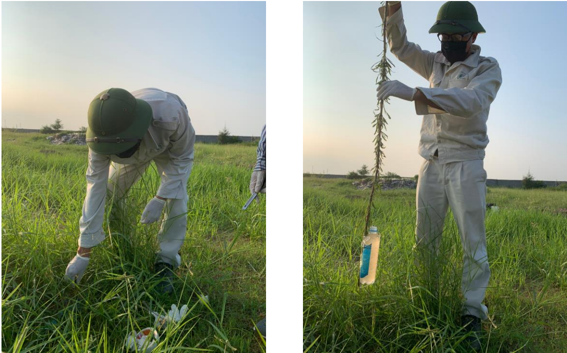
Hình 4.1. Lắp đặt hệ thống thu nước ngầm từ điểm chôn lấp sau đốt và lấy mẫu nước ngầm
